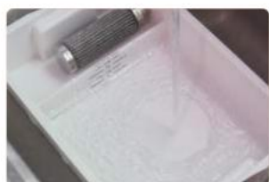
4. Töltse fel a hűtőfolyadék tartályát víz a 2,5 literes jelzésig
