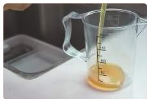
5. Öntsön 250 ml vágófolyadékot folyadék a hűtőfolyadék-tartályba
