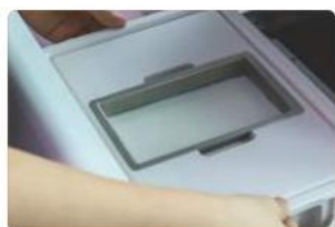
7. Helyezze vissza a hűtőfolyadék-tartályt a gépet, és húzza meg biztonságosan
