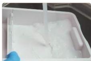
3. Használjon tiszta vizet az öblítéshez és tisztítsa meg a hűtőfolyadék tartályát
