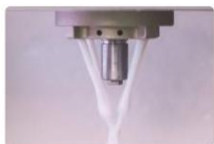
8. Kattintson a „Hűtőfolyadék” gombra az ellenőrzéshez. Ha a hűtőfolyadék megfelelően permetez, akkor a gép üzemkész.
